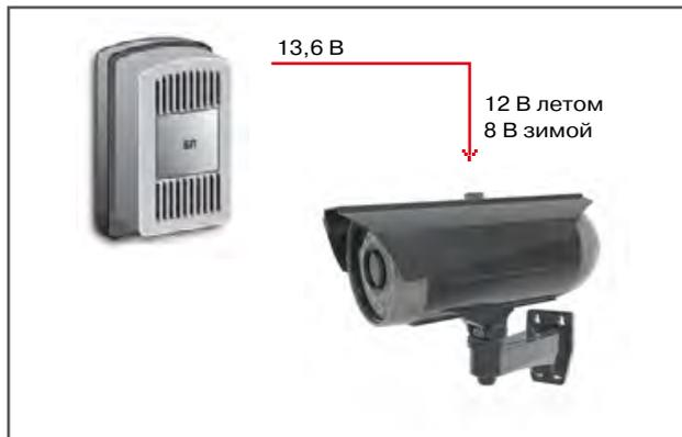
Блок питания с повышенным выходным напряжением
