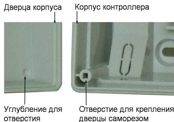
Рисунок 6. Схема «жесткого» крепления дверцы к корпусу контроллера
