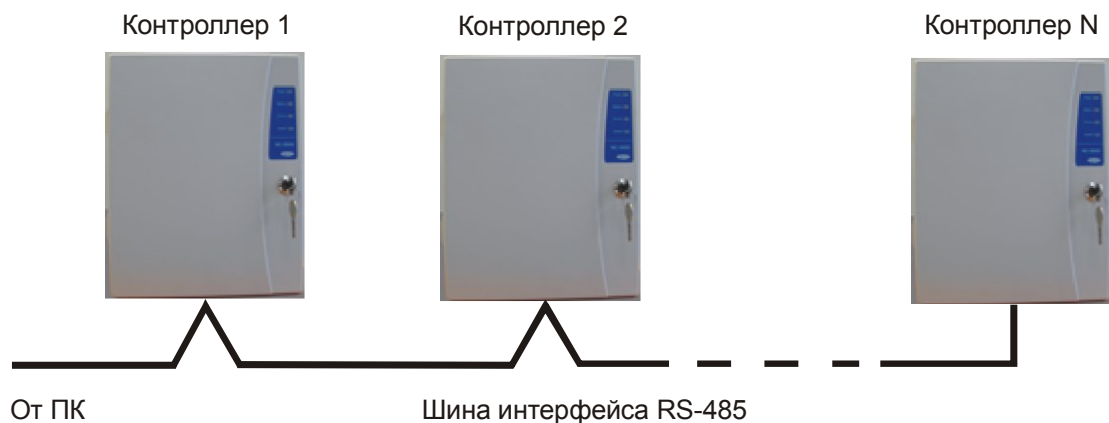
Рисунок 26. Соединение контроллеров по топологии «Шина»
