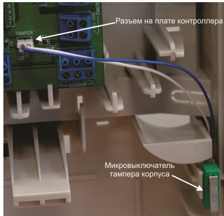
Рисунок 21. Подключение тампера корпуса
