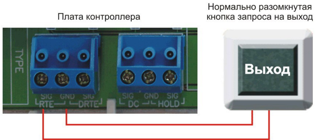
Рисунок 15. Схема подключения кнопки запроса на выход
