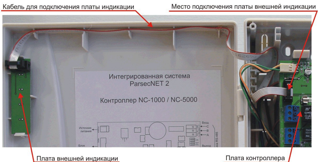
Рисунок 25. Схема подключения платы внешней индикации
