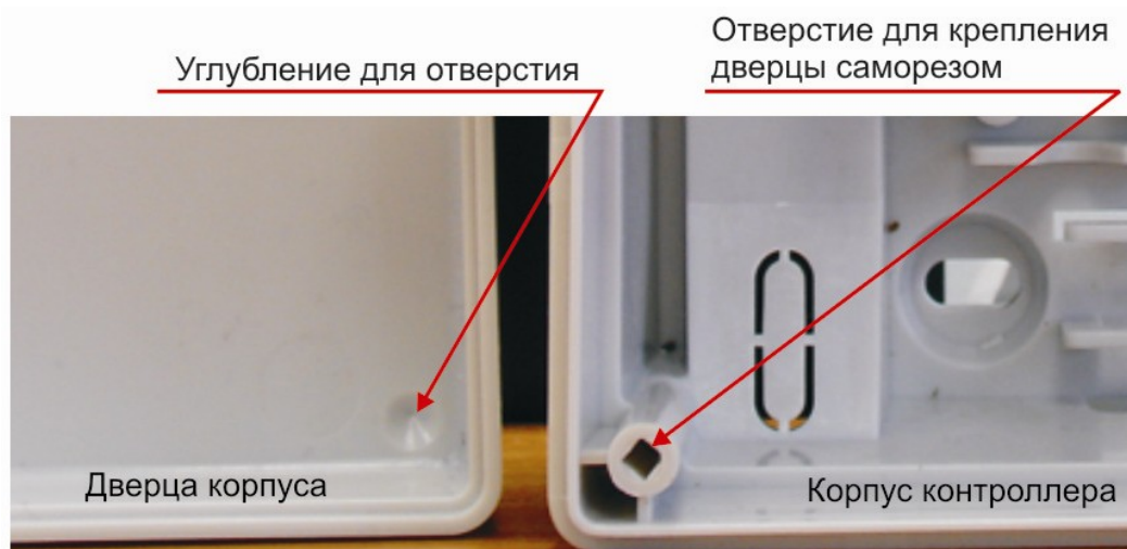
Рисунок 3. Схема «жесткого» крепления дверцы к корпусу контроллера.
