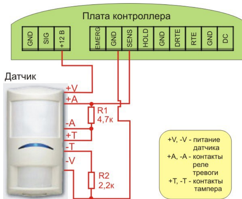
Рисунок 12. Подключение охранного датчика с контролем подводящих проводов
