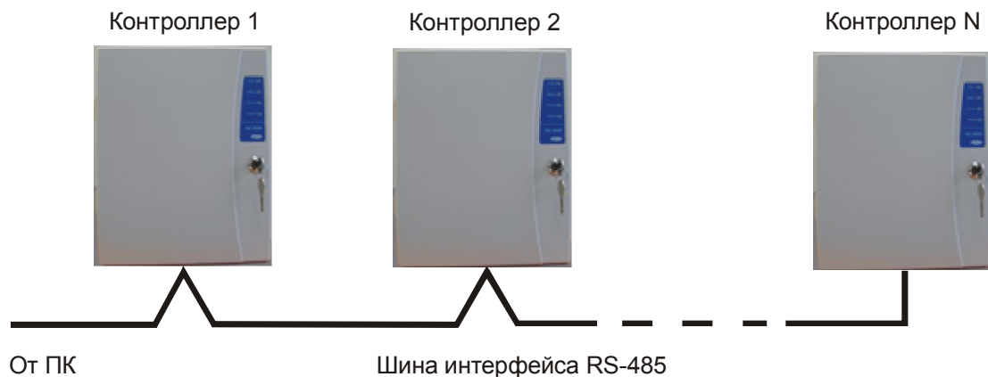
Рисунок 17. Соединение контроллеров по топологии «Шина»
