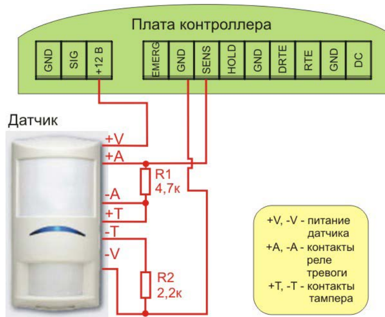
Рисунок 12. Подключение охранного датчика с контролем подводящих проводов
