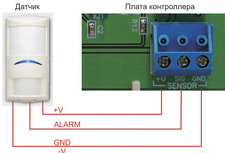
Рисунок 18. Подключение охранного датчика без контроля подводящих проводов
