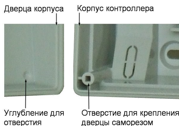
Рисунок 5. Схема «жесткого» крепления дверцы к корпусу контроллера
