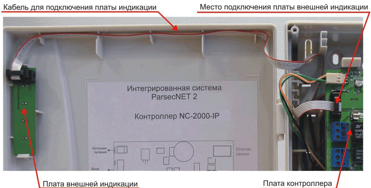
Рисунок 24. Схема подключения платы внешней индикации
