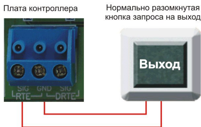
Рисунок 14. Схема подключения кнопки запроса на выход
