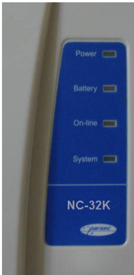
Рисунок 23. Внешняя индикация состояний контроллера.
