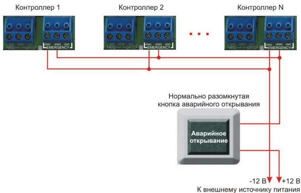
Рисунок 22. Подключение одной кнопки к нескольким контроллерам.
