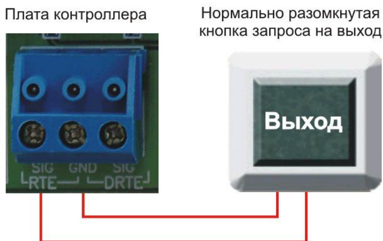
Рисунок 9. Схема подключения кнопки запроса на выход.
