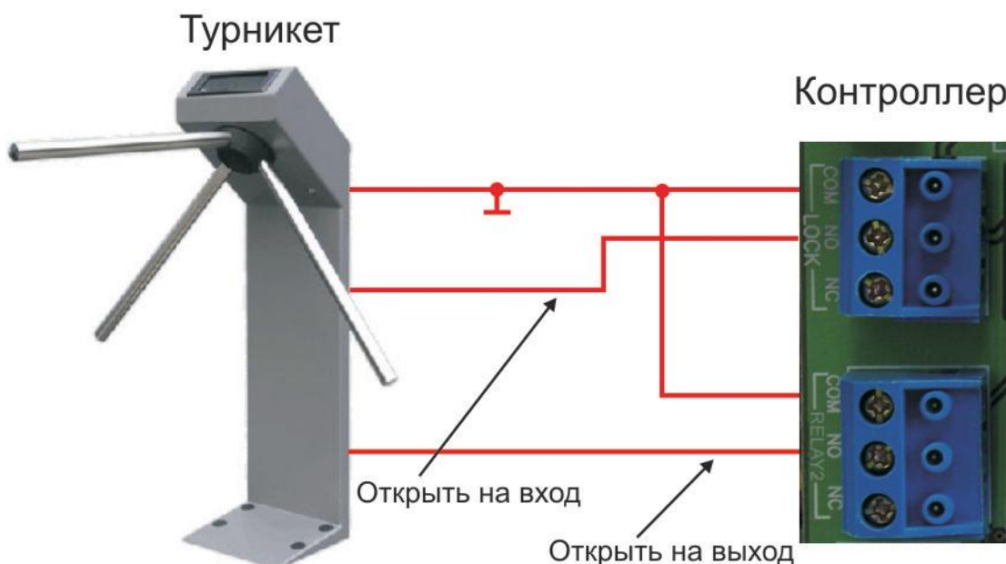
Рисунок 14. Управление турникетом контроллерами.
