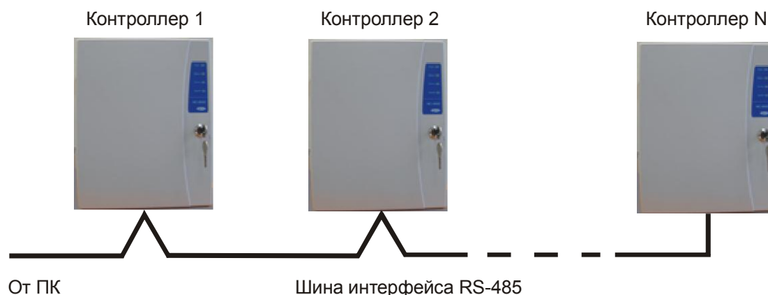
а). Соединение контроллеров по топологии «Шина».
