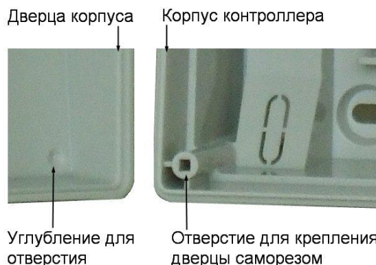
Рисунок 5. Схема «жесткого» крепления дверцы к корпусу контроллера
