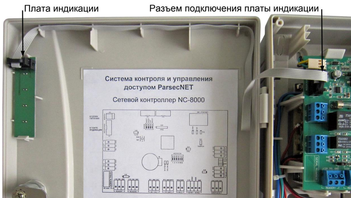
Рисунок 25. Подключение платы внешней индикации
