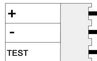
Рисунок 3. Назначение контактов разъема POWER
