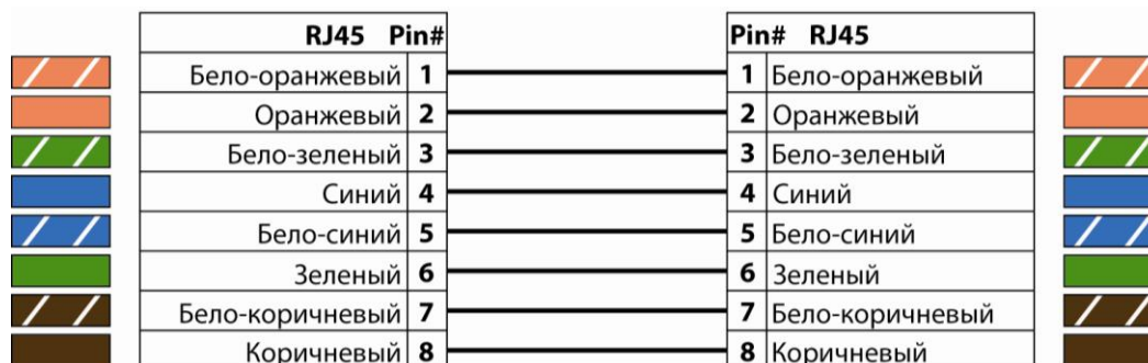
Рисунок 17. Прямая схема обжима кабеля
