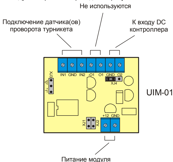
Рисунок 1. Плата модуля сопряжения UIM-01.
