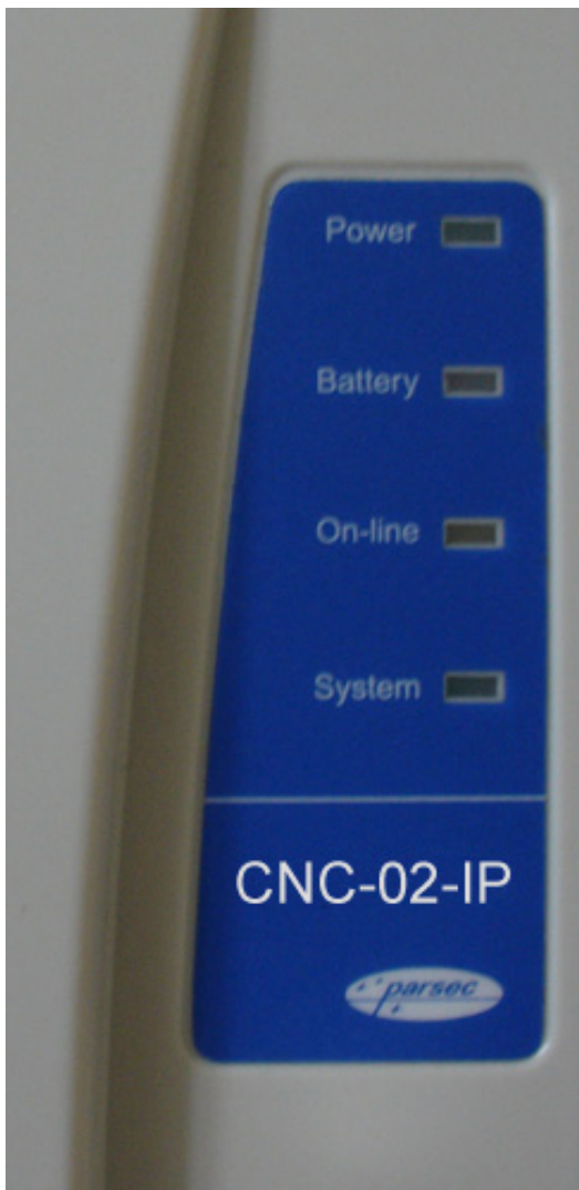
Рисунок 6. Внешняя индикация состояний контроллера.
