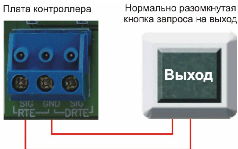
Рисунок 9. Схема подключения кнопки запроса на выход.
