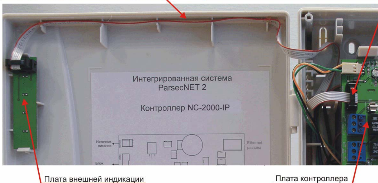
Рисунок 21. Схема подключения платы внешней индикации.
