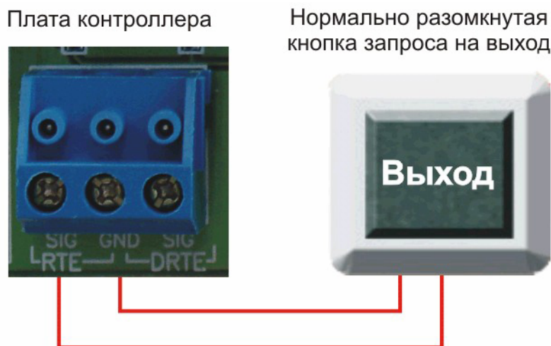
Рисунок 9. Схема подключения кнопки запроса на выход.
