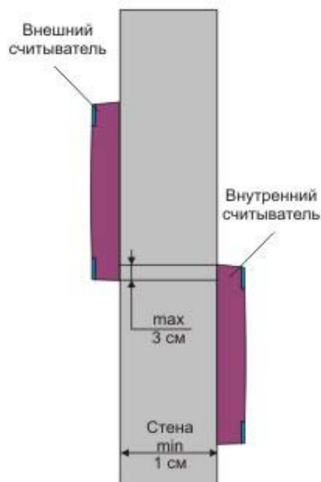
Рисунок 5. Крепление считывателей с разнесением по вертикали.
