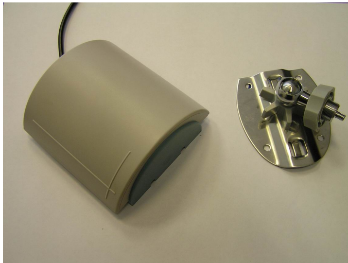
Рисунок 2. Выносная антенна для считывателя.
